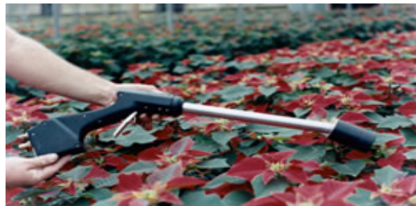
Figura 15. Pistola para la fumigación electrostática de invernaderos, paisajes interiores o plantas en viveros.
