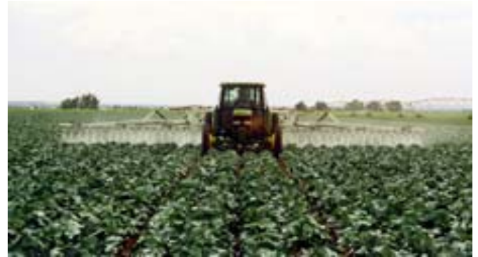
Figura 3. Un fumigador electrostático con enganche de tres puntos en un campo de calabaza. La carga electrostática asegura una cobertura uniforme de la planta.
