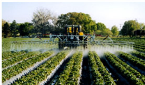
Figura 8. Fumigador electrostático diseñado para cultivos de fila.
