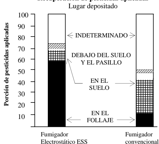
Figura 17. El depósito del vapor en los varios sitios del invernadero, comparando el sistema electrostático con el hidráulico convencional.
