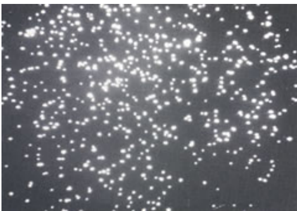
Figura 20. Esta es la misma sección de la hoja que se ve en la figura anterior. Un intensificador de luz y un filtro óptico se han instalado en la cámara con lente magnificadora. Estos aparatos filtran las imágenes del fondo y sacan a luz hasta las partículas fluorescentes más pequeñas.
