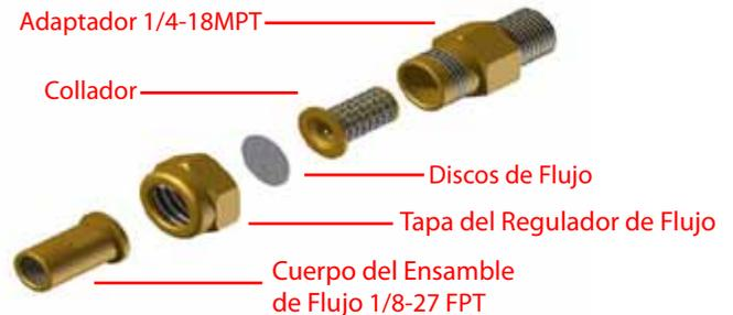
**Una vista detallada del montaje desmontado del disco del flujo. Tome por favor la nota de la orden correcta.**
